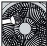
Pour enlever la poussière à l'intérieur et sur les grilles, utilisez un aspirateur avec embout adapté. Ne désassemblez pas le ventilateur pour le nettoyer.
