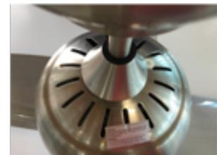
3/ Placez les 2 coupelles sur le tube, enlevez le kit boulon-goupille du moteur ainsi que les 2 vis, passez les fils à l'intérieur du tube et positionnez le tube correctement sur le moteur (1 seul sens possible, rotule noire vers le plafond). Remettez le kit boulon-goupille en faisant attention de ne pas abimer les fils passant à l'intérieur et resserrez les 2 vis.
